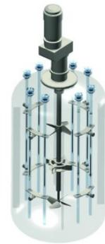
Abb. 2: Industrieller Photoreaktor
