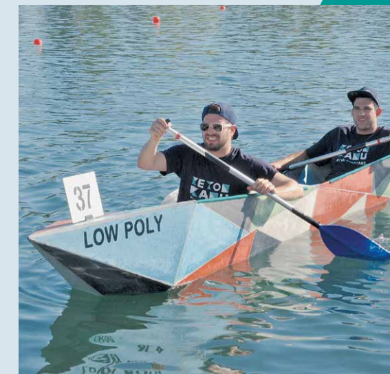
Mit den Booten Low Poly (im Bild) und Herold gingen die Studierenden in diesem Jahr bei der Betonkanu-Regatta an den Start. Low Poly ist fünf Meter lang und 100 Kilogramm schwer.
